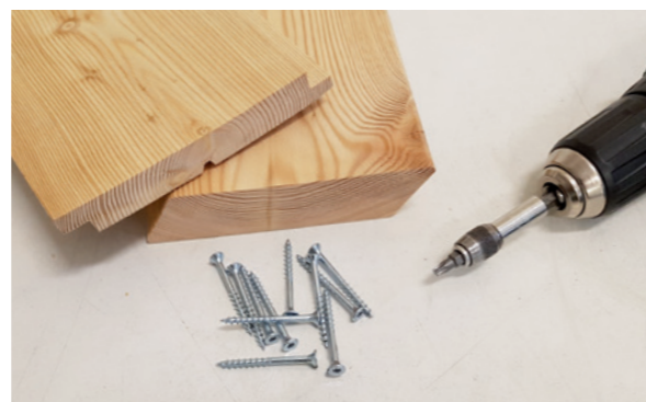
1. Für die fachgerechte Vormontage verwenden Sie bitte Edelstahlschrauben 5 x 60 mm (Teilgewinde) mit Bohrspitze und Fräsrippen.
