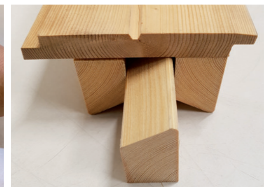
4. Die Deckbreite der Wechselfalzprofile entspricht genau viermal der Stärke eines Parallelogramms. So können Sie die Parallelogramme als Abstandhalter nutzen.
