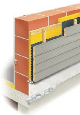
Structure d'un mur en construction en dur.
